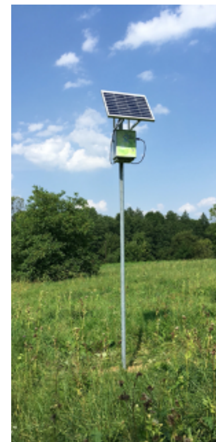
Obr. 3 Senzorická jednotka umístěná v experimentální oblasti Zdroj: Vysoká škola Báňská, Institut environmentálních technologií (IET)
