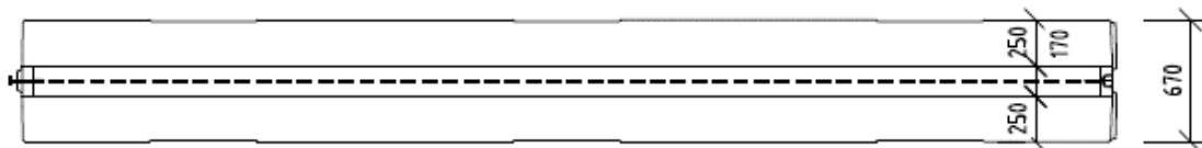
Obrázok 3 – Bežný dielec zvodidla dĺ. 6 m
