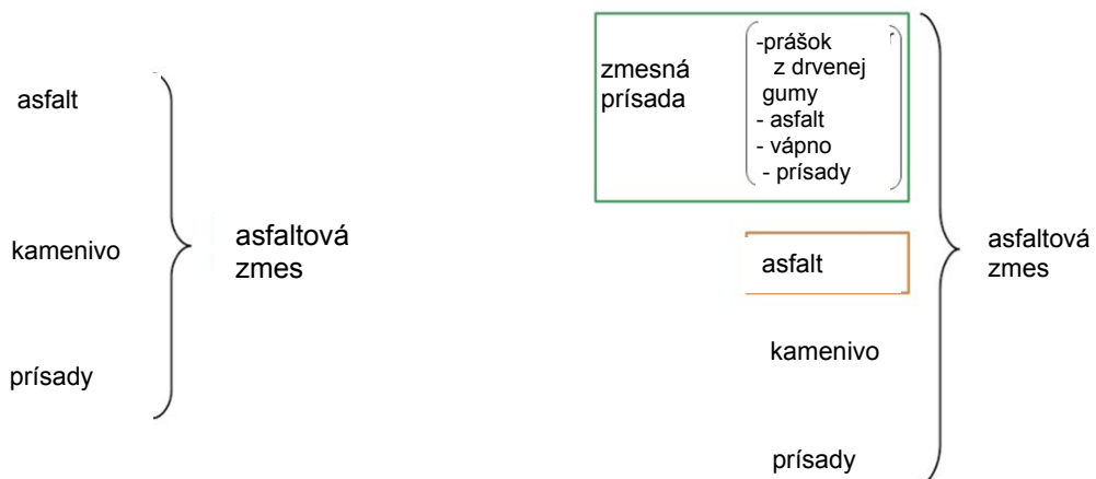
Obrázok 1.2.1.1 – Typické zloženie asfaltovej zmesi (pre zmesi podľa harmonizovaných noriem)
